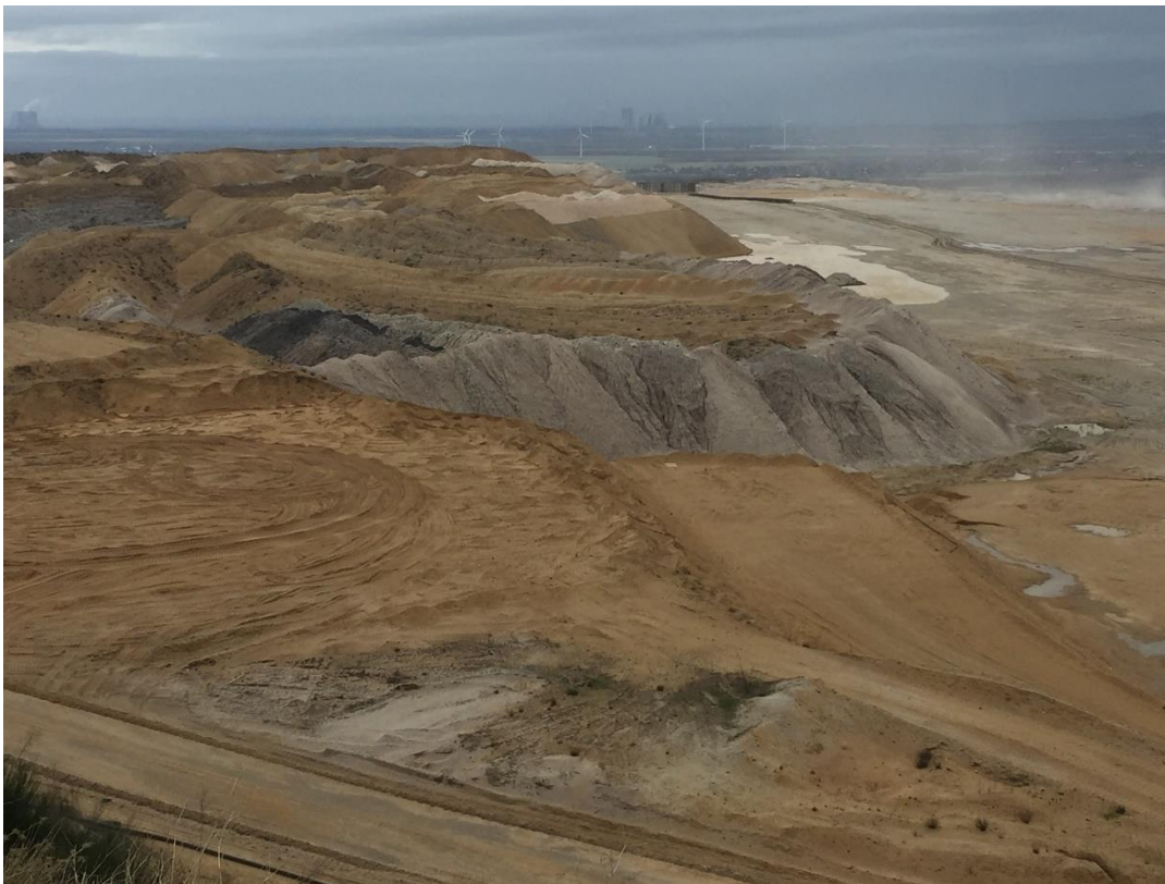
Bild 2: Blick nach Osten von höchster Kippkante, Höhenunterschied ca. 50 bis 60 m bis zum Weg, bis Oberkante Gelände Umland ca. 150 m Höhenunterschied, Verkippung hier fast ausschließlich tragfähiger Massen (2020)
