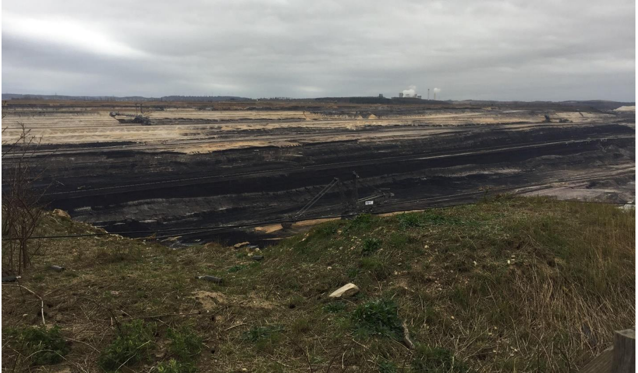
Bild 5: Blick in TB Inden; dort große Flözmächtigkeit und relativ geringe Überdeckung sichtbar
